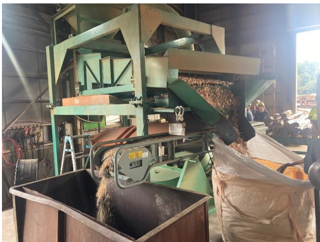
▲自社で丸太材を木チップに加工、 トンパックに詰めて大量に保管
