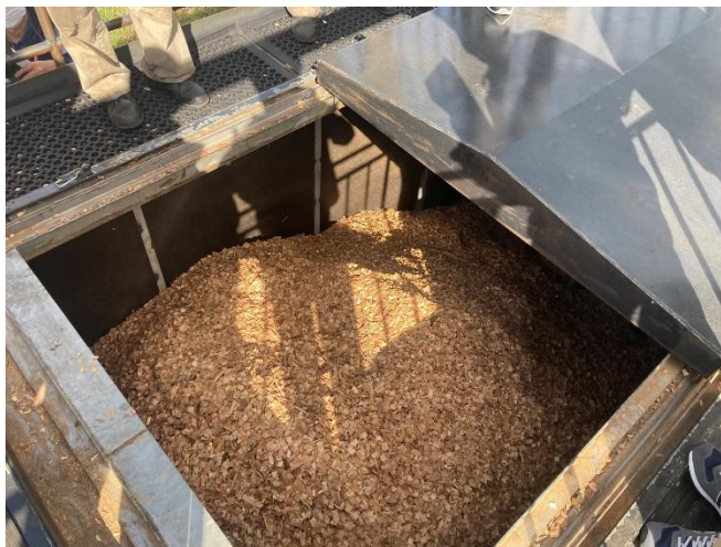
▲この1機で年間400m 3 の木チップ を使用する。約3日分を貯蓄可能
